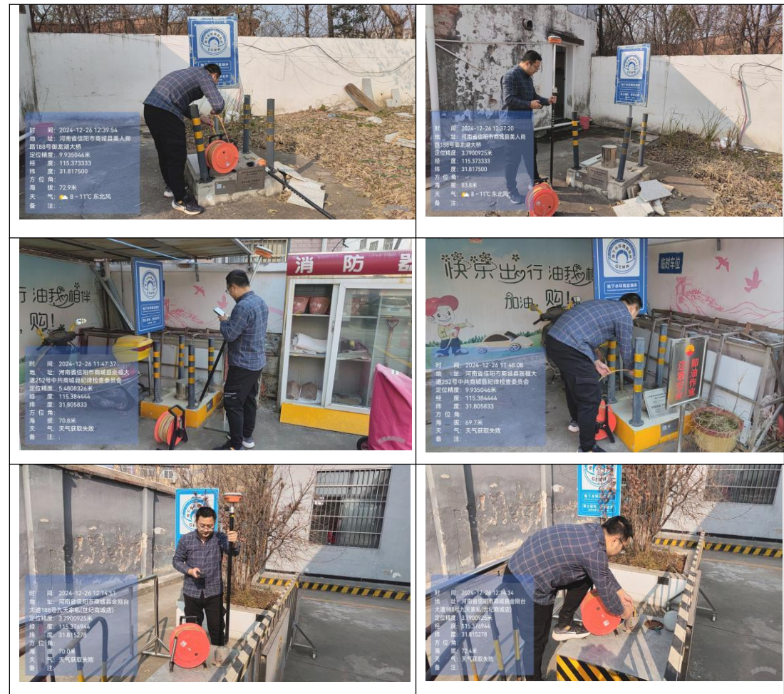
图 3-13 量取水井地下水位现场图
