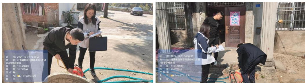
图 3-10 量取水井地下水位现场图
