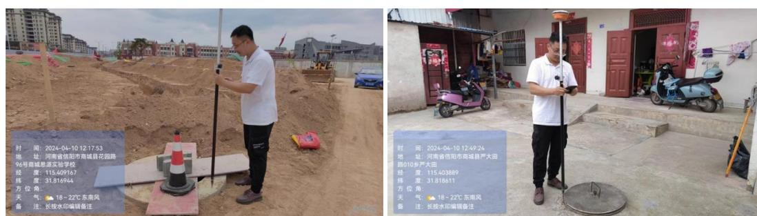
图 3-6 量取水井地下水位现场图
